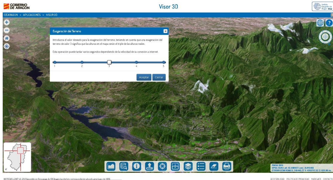
Figura Nº 11. Ejemplo de exageración del terreno con un factor de aumento = 3.
